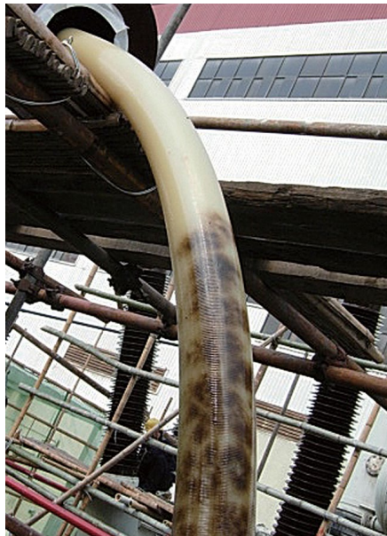
图 2. 左图: 褐色斑纹为电缆绝缘层在水分和电场同时作用下而产生的水树现象; 右图: 水分在电场作用下不断聚集在水树的缺陷部位, 导致绝缘层产生机械损伤, 从而影响电缆的正常运行。
