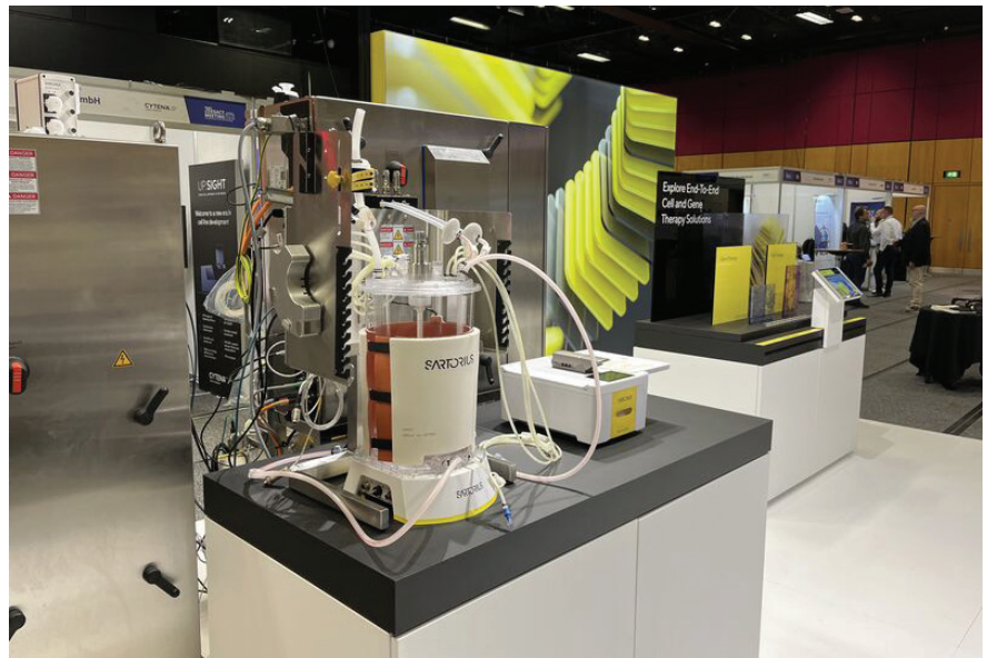
ABBILDUNG 4 Der Univessel® SU mit nahtlos installiertem Heizmantel.
